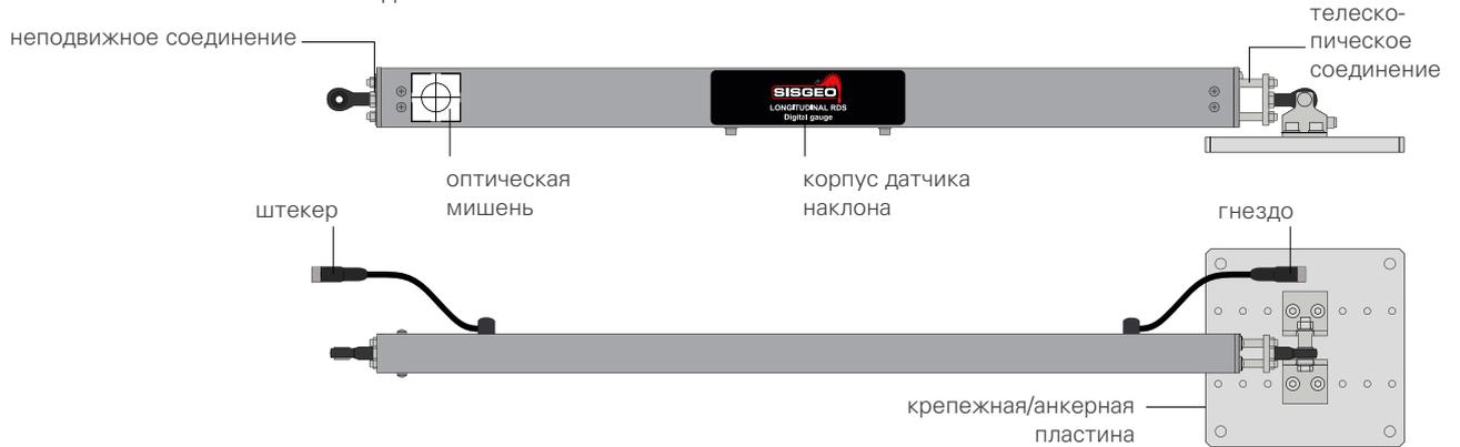
Система **RDS-T (анализа поперечной деформации)** используется для мониторинга перегиба железнодорожного пути. Данная система включает в себя цифровой датчик (наклона и температуры), закрепленный на пластине. Пластина располагается на шпале и подсоединяется к системе RDS-L при помощи соединителей.
